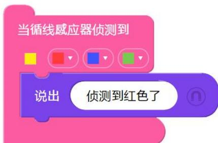
循线时前进时，侦测到黄红蓝绿的颜色组合，说出侦测到红色了。
